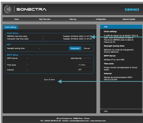
**DBMx03 real time clock**: Date et heure de l'horloge interne de l'afficheur
