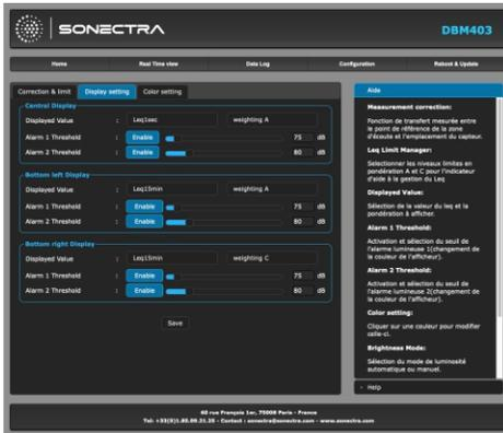
Cette page permet de configurer pour chacun des trois afficheurs les seuils des niveaux sonores indiqués *Alarm 1 Threshold* et *Alarm 2 Threshold*.
