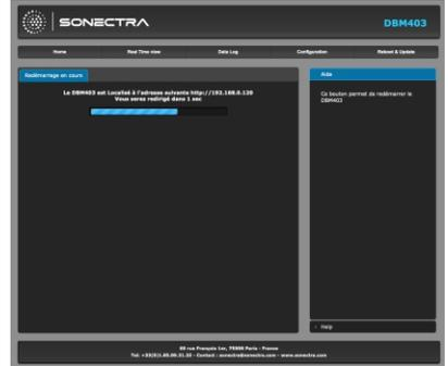
Pour fonctionner correctement, l'adresse IP du DBM doit être d'une part unique dans le sous réseau, et d'autre part elle doit appartenir à la plage d'adresse IP disponible.
