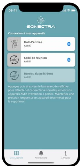
← Visualisation des appareils AMIseries détectés dans la zone de réception. La portée de connexion du bluetooth de l'AMI17 est de 10 mètres.
