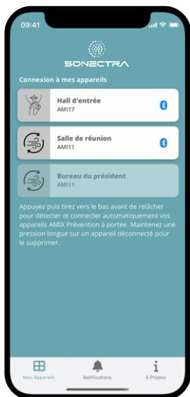
← Visualisation des appareils AMIseries détectés dans la zone de réception. La portée de connexion du bluetooth de l'AMI11 est de 10 mètres.
